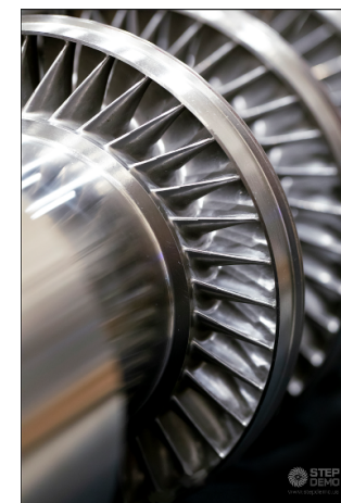
715°C 255 bar sCO 2 Turbine Rotor
